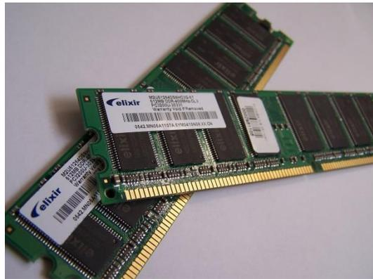
Das liegt daran, dass man inzwischen extrem kleine Transistoren bauen kann. Eigentlich werden die Transistoren nicht einmal gebaut, sondern mit Chemikalien in eine Folie geätzt. Und diese Transistoren sind dann so klein, dass auf einen Arbeitsspeicher - wie er oben zu sehen ist – locker ein paar Millionen Transistoren passen!
